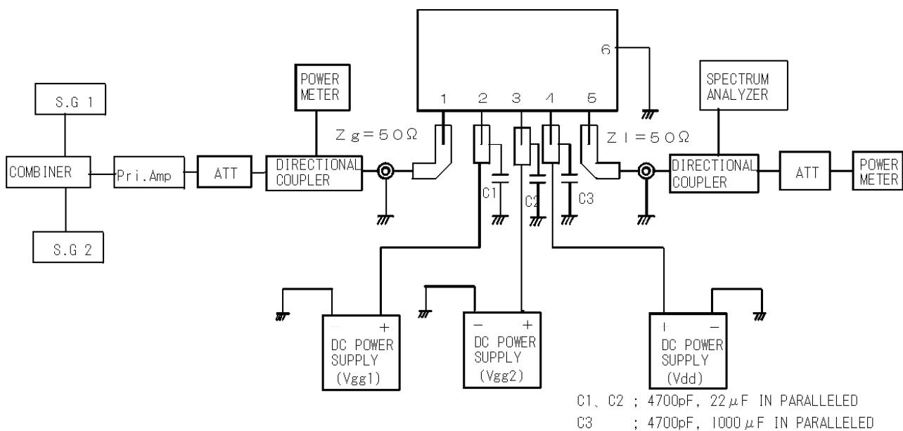
TEST BLOCK DIAGRAM (SINGLE CARRIER)
